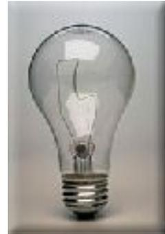
Der Glühfaden besteht aus **Wolfram**. Dieses Metall schmilzt erst bei 3400°C. In der Lampe erreicht es eine Temperatur von **2500-3000°C**. Der Glühfaden ist **gewandelt** (gedreht). Wenn er zweimal gewandelt wird, passt mehr Draht in die Lampe und sie gibt auch mehr Licht.
